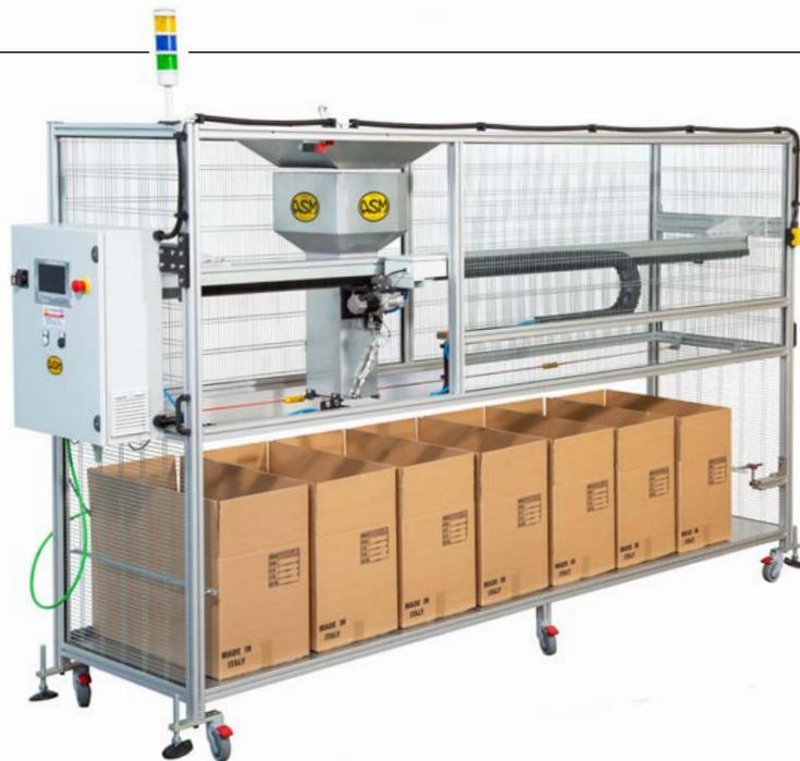
**SMAC È COSTITUITO DA UN ASSE MOTORIZZATO INSTALLATO SU UNA STRUTTURA IN ESTRUSO DI ALLUMINIO. L'ASSE MOVIMENTA UN SISTEMA DI SMISTAMENTO DEL PRODOTTO CHE CONVOGLIA IL PRODOTTO STESSO NEL GIUSTO CONTENITORE, IL QUALE PUÒ ESSERE DI NUMERO E DI DIMENSIONI VARIABILI.**
